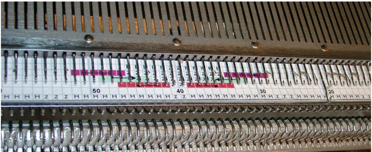
Der Muster-Orientierungsstreifen wird einfach unter die Nadeln des Hauptbettes geschoben.
